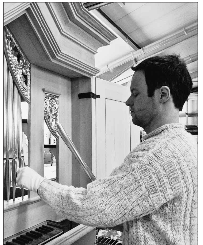
Letzte Handgriffe: Der Orgelbauer setzt die Zinnpfeifen ein. Damit er keine Flecken hinterlässt, trägt er für diesen finalen Schritt Handschuhe.
