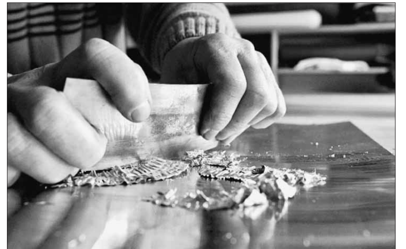
Die fertige Zinnplatte muss sorgfältig gehobelt und poliert werden, ehe sie weiterverarbeitet wird.
