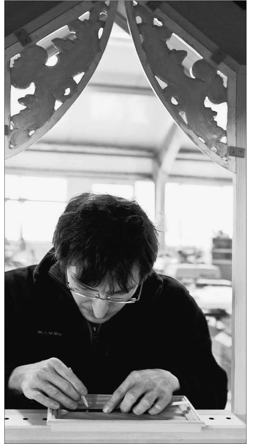
Der angehende Orgelbaumeister Uli Skriwan zeichnet ein, an welcher Stelle Löcher für die Montage gebohrt werden müssen.
