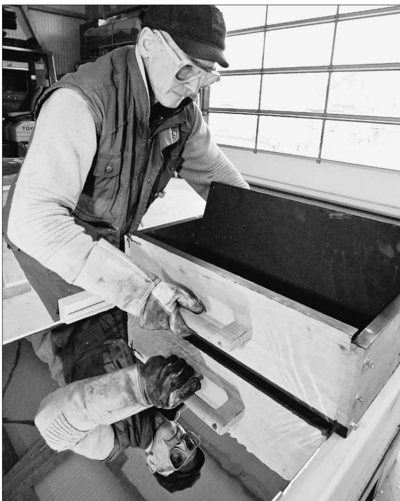
Josef Maier stellt mit einem Zinnschlitten die dünnen Platten her, die er für den Bau von Orgelpfeifen benötigt.
