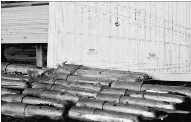
Mehr als ein Dutzend Pfeifenrohlinge wartet darauf, in der Orgel eingebaut zu werden.
